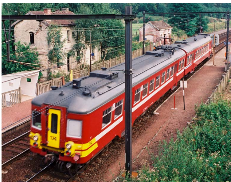
Foto 3 – Niet-gemoderniseerde klassieke tweeledige AM 66-79
